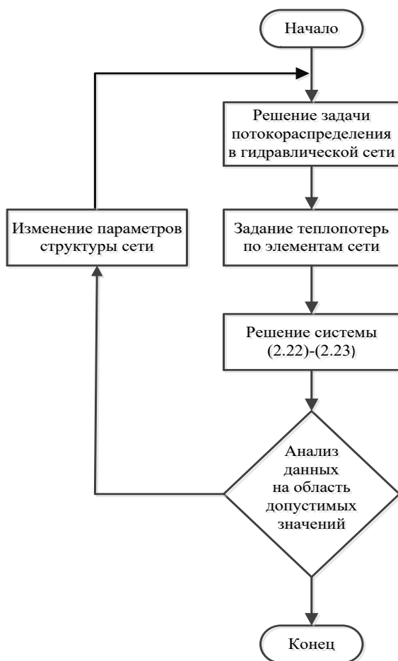
Рисунок 3.3 – Блок схема алгоритма управления тепловой сетью
